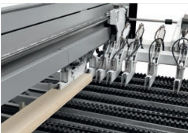
Sistema para execução simultânea de cortes transversais diferenciados composto por dois empurradores, totalmente independentes entre eles, e uma pinça ociosa (sem motor), totalmente independente.
