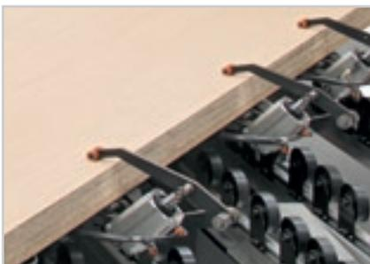
Os dispositivos de bloqueio dos painéis evitam desfazer o pacote durante a rotação.
