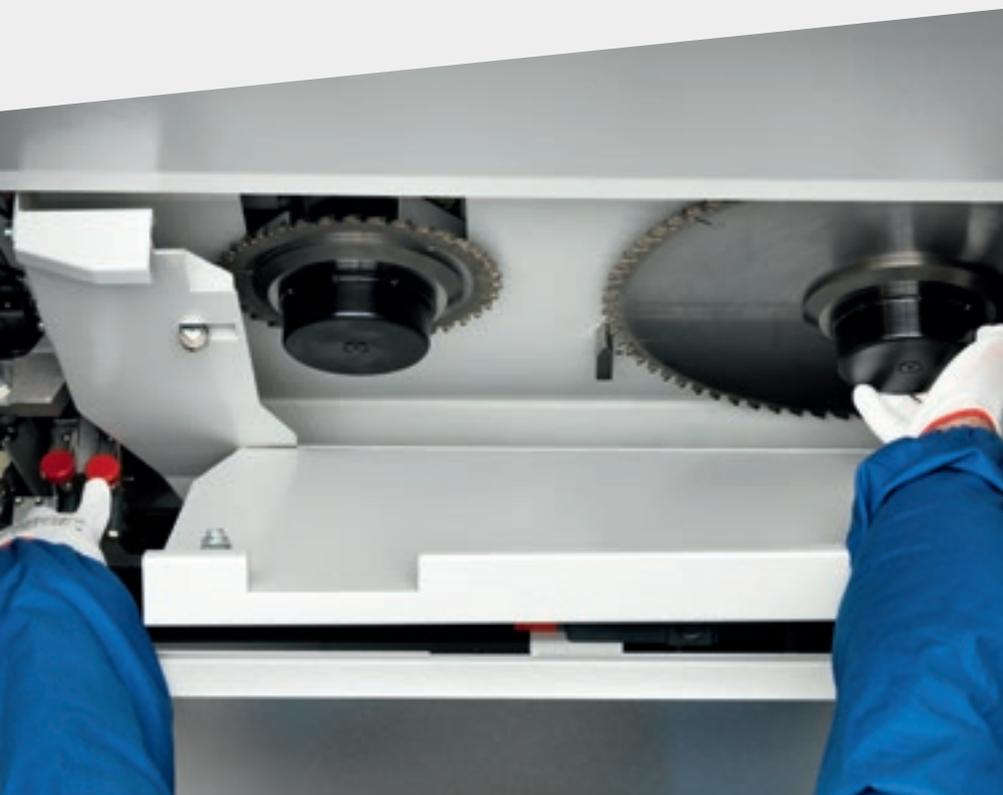
O sistema Quick change é o dispositivo mais rápido, ergonômico e seguro para a substituição das lâminas sem o uso de ferramentas.
