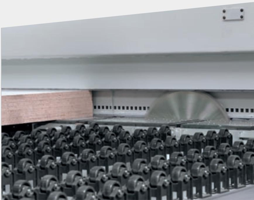
A prensa dupla possui uma estrutura duplicada e independente, que permite uma pressão homogênea e controlada sobre o pacote de painéis a serem cortados, graças à ausência de aberturas para a passagem das pinças e cria uma verdadeira câmara hermética nos cortes de acabamento, permitindo uma aspiração eficaz do pó.
